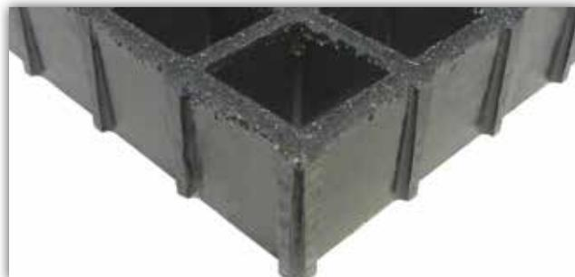
**Surface supérieure à grains appliqués intégralement :** La surface grenue en option de Fibergrate® est traitée par des grains de quartz appliqués intégralement, puis durcis et scellés la surface, créant une zone d'appui fortement antidérapante.
